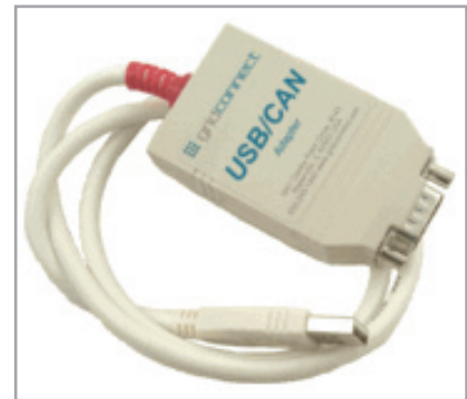
Konverteren har ordre-nummer: USB-CAN1-1-0.6-DSUB,
