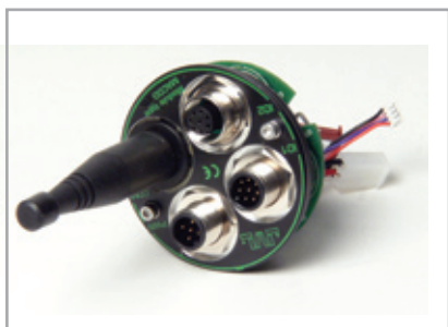
Bluetooth modulet MAC00-FB4 der kan monteres i alle JVL's MAC motorer
