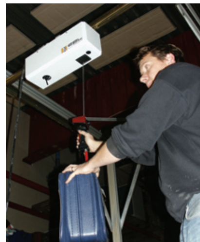
Håndgrebet med taster for op- og nedkørsel af taljen og indbygget Bluetooth
