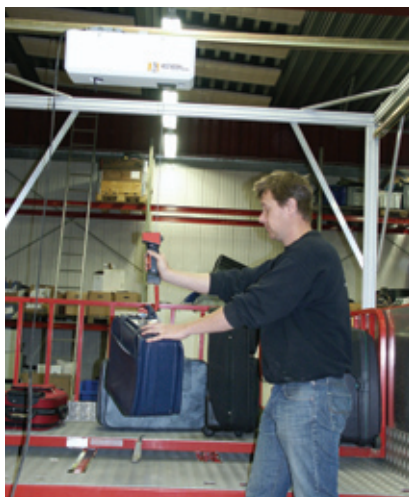
Taljen med håndgrebet og boksen med MAC800 indbygget
